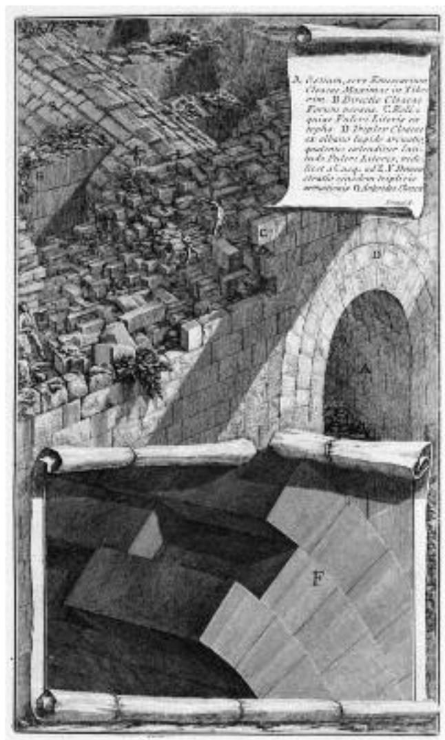
Fig. 61 - Dettaglio della triplice ghiera in blocchi e dell'estradosso della volta allo sbocco della Cloaca Massima in una incisione di G.B. Piranesi (PIRANESI 1761, Tav. III).
